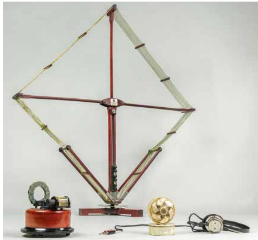
Ensemble aus einem Detektorempfänger mit Aufsteckdetektor „Rotstern“, um 1925, Raumlautsprecher, um 1935, zusammenklappbare Rahmenantenne, um 1925, und Kopfhörer aus den 1920er-Jahren
