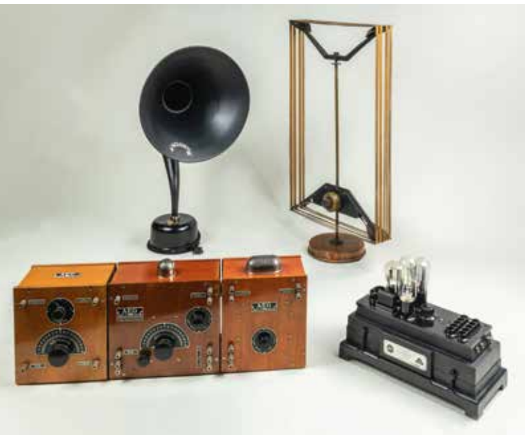
Der Rundfunkempfänger A I, Niederfrequenzverstärker A II und Antennenkoppler A III von 1924 sind zum AEG-D-Zug verbunden; mit dabei ein Netzanschlussgerät, um 1928, ein Trichterlautsprecher von AEG, um 1925, und eine Rahmenantenne, um 1930
