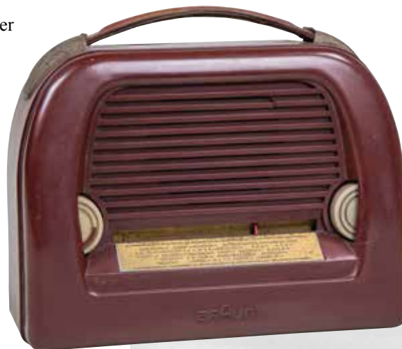
Mobil sein und Radio hören: Das Braun Piccolino 51, ein Röhren-Kofferradio von 1951/52, funktionierete mit Batteriebetrieb und mit Netzteil
